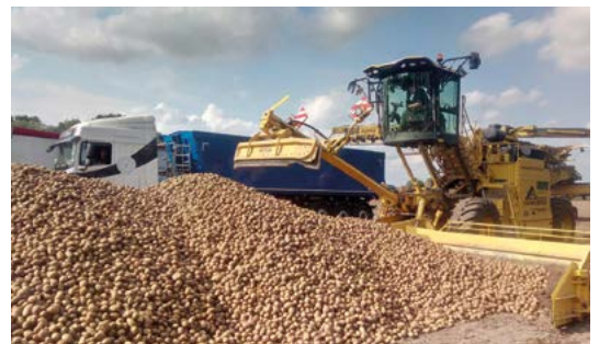
Kartoffellademaus zum Verladen von Stärkekartoffeln, Umbau mit Hessels Produkten.
