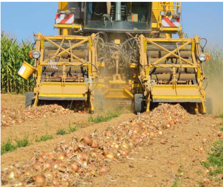
Umgebauter Ropa Tiger Rübenroder zum selbstfahrenden Zwiebelsammler mit Hessels Bändern u. Zubehör.
