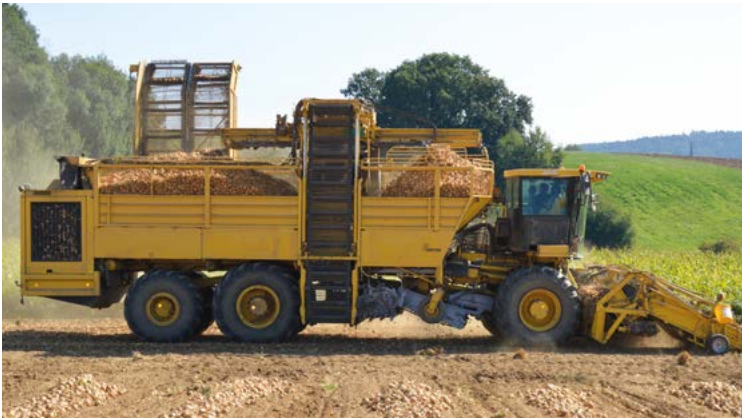
Umgebauter Ropa Tiger Rübenroder zum selbstfahrenden Zwiebelsammler mit Hessels Bändern u. Zubehör.
